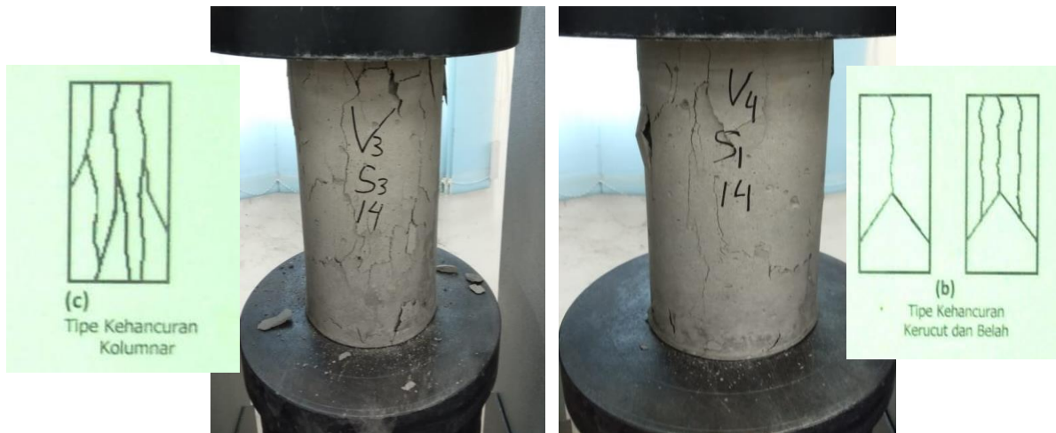
Beton V3-S3-14 Pola Retak Kolumnar
