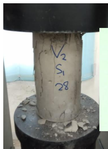
Beton V2-S1-28 Pola Retak Kolumnar
