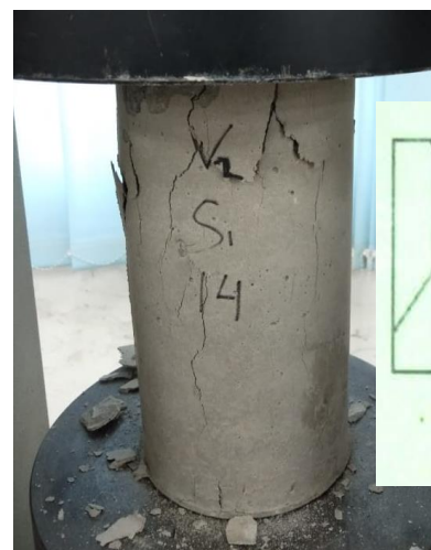
Beton V2-S1-14 Pola Retak Kerucut dan Belah
