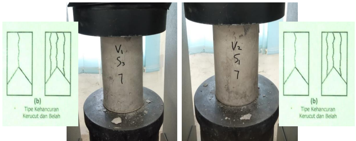
Beton V1-S3-7 Pola Retak Kerucut dan Belah Beton V2-S1-7 Pola Retak Kerucut dan Belah
