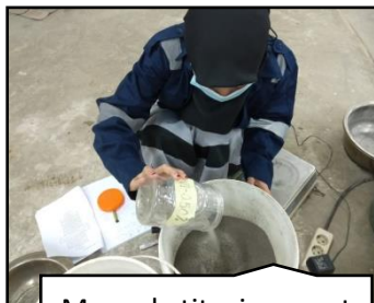
Mensubstitusi agregat plastik kedalam pasir
