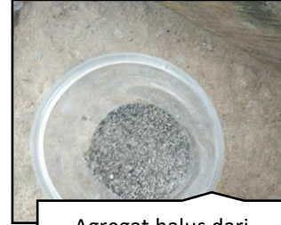
Agregat halus dari limbah kantong plastik
