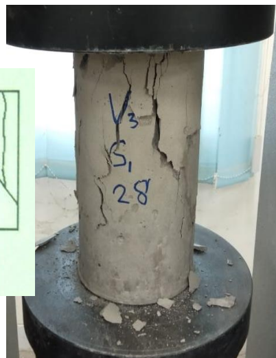
Beton V3-S1-28 Pola Retak Kerucut dan Belah
