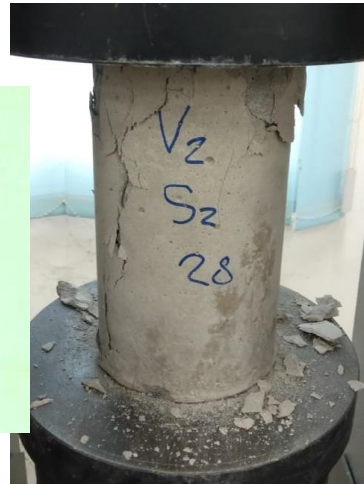
Beton V2-S2-28 Pola Retak Kolumnar
