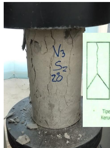
Beton V3-S2-28 Pola Retak Kerucut dan Belah
