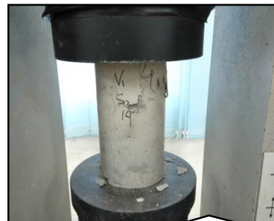
Pengujian kuat tekan beton dengan UTM
