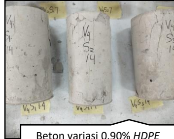
Beton variasi 0.90% HDPE umur 14 hari yang telah melalui pengujian kuat tekan
