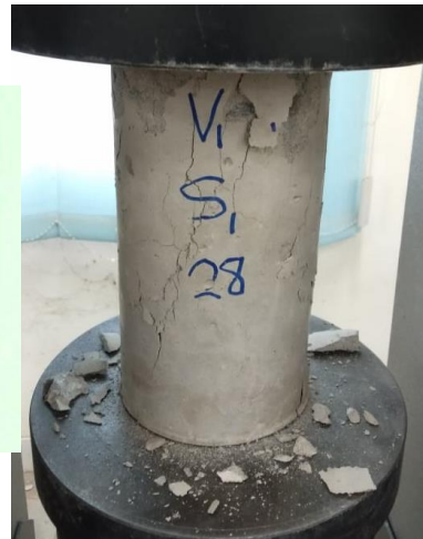
Beton V1-S1-28 Pola Retak Kerucut dan Belah
