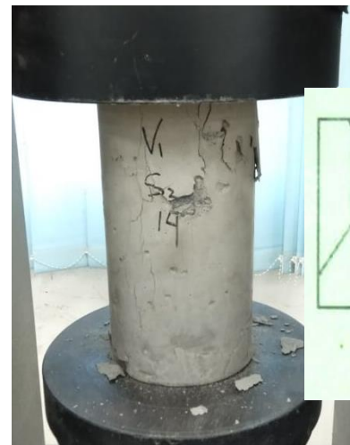
Beton V1-S2-14 Pola Retak Kerucut dan Belah
