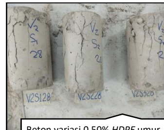
Beton variasi 0.50% HDPE umur 28 hari yang telah melalui pengujian kuat tekan
