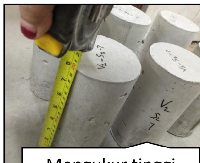
Mengukur tinggi beton
