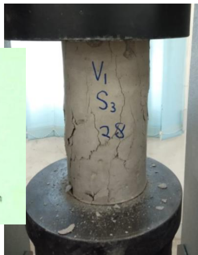
Beton V1-S3-28 Pola Retak Kolumnar
