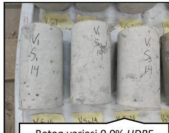
Beton variasi 0.0% HDPE umur 14 hari yang telah melalui pengujian kuat tekan
