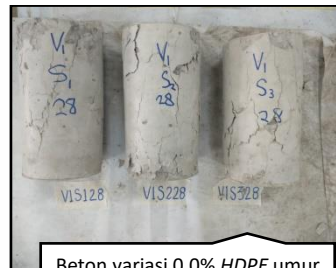
Beton variasi 0.0% HDPE umur 28 hari yang telah melalui pengujian kuat tekan
