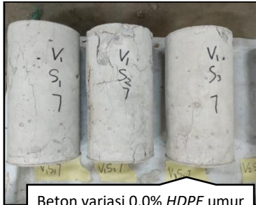
Beton variasi 0.0% HDPE umur 7 hari yang telah melalui pengujian kuat tekan
