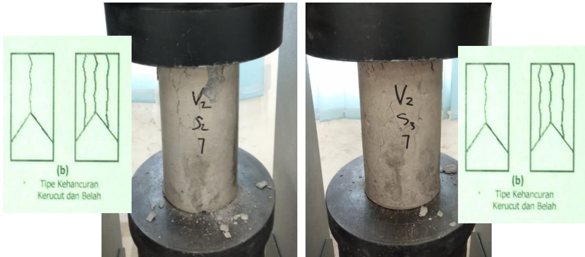
Beton V2-S2-7 Pola Retak Kerucut dan Belah
