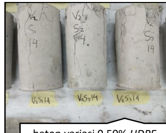
beton variasi 0.50% HDPE umur 14 hari yang telah melalui pengujian kuat tekan
