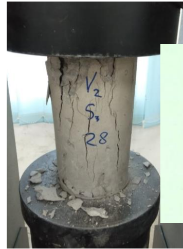
Beton V2-S3-28 Pola Retak Kolumnar
