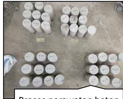
Proses perawatan beton dengan dry curing
