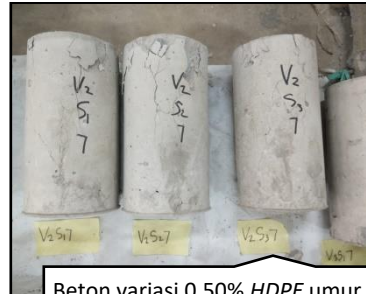
Beton variasi 0.50% HDPE umur 7 hari yang telah melalui pengujian kuat tekan
