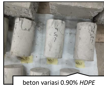
beton variasi 0.90% HDPE umur 7 hari yang telah melalui pengujian kuat tekan
