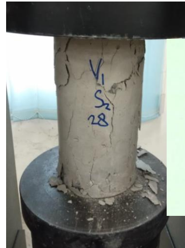
Beton V1-S2-28 Pola Retak Kolumnar
