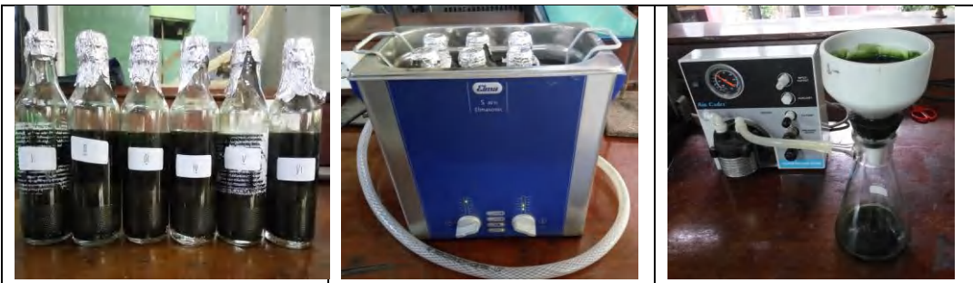
Proses pelarutan dalam botol vial, ekstraksi dengan sonikator dan penyaringan dengan buchner sampel daun A. muricata L.
