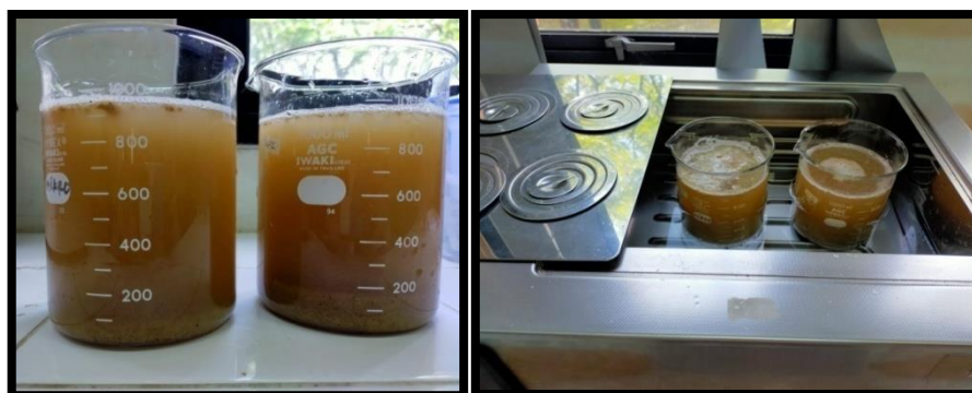
Gambar 6. Proses pemanasan tepung alga K. alvarezii menggunakan 50 gram tepung alga dan 1.950 ml aquades dengan water batch selama 2 jam pada suhu 100°C
