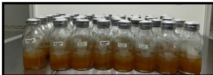
Gambar 12. Proses hidrolisis dengan Trichoderma reesei pada suhu \pm 30^{\circ}\text{C} (suhu ruang)
