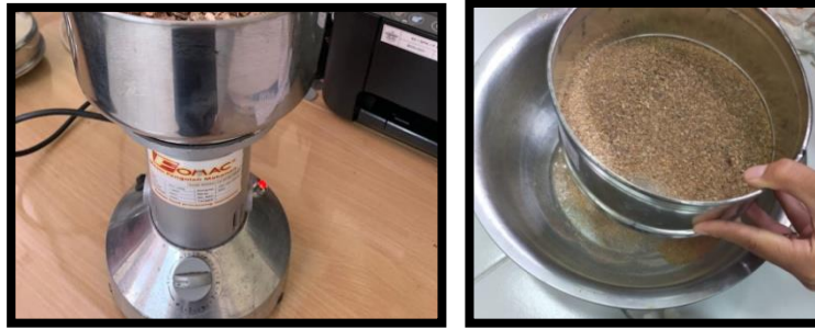
Gambar 4. Proses penghalusan dan pengayakan limbah alga K. alvarezii dengan ayakan 40 mesh
