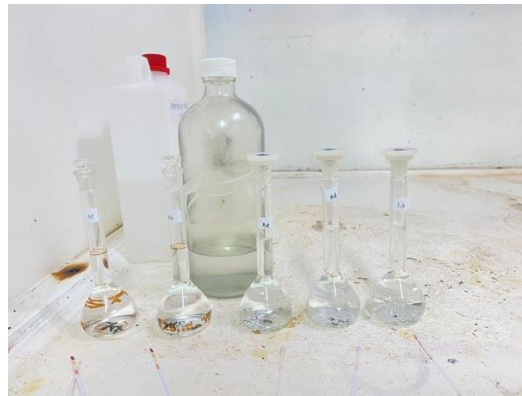
Gambar 10. Pembuatan larutan standar tembaga
