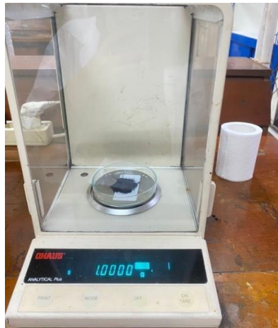
Gambar 7. Proses penimbangan karbon aktif ampas tebu untuk analisis kadar air
