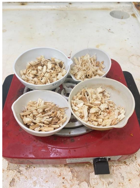
Gambar 2. Ampas tebu dipanaskan di atas hotplate
