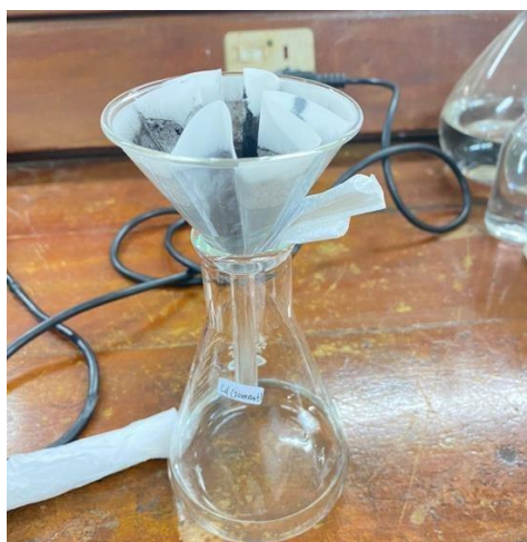
Gambar 13. Proses penyaringan karbon aktif ampas tebu yang telah diadsorpsi
