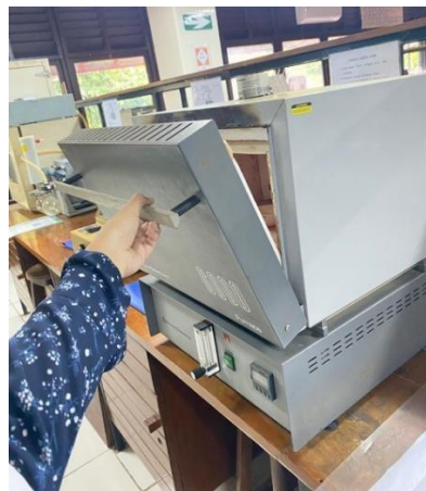
Gambar 8. Karbon aktif ampas tebu dimasukkan ke dalam tanur pada proses analisis kadar abu
