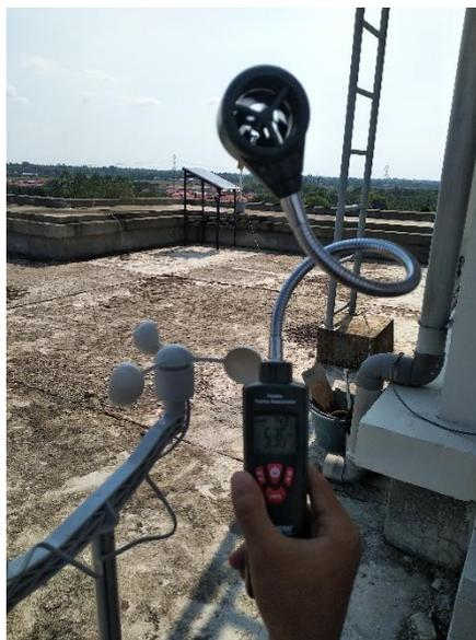
Gambar 2. 10 *Kalibrasi Anemometer*
