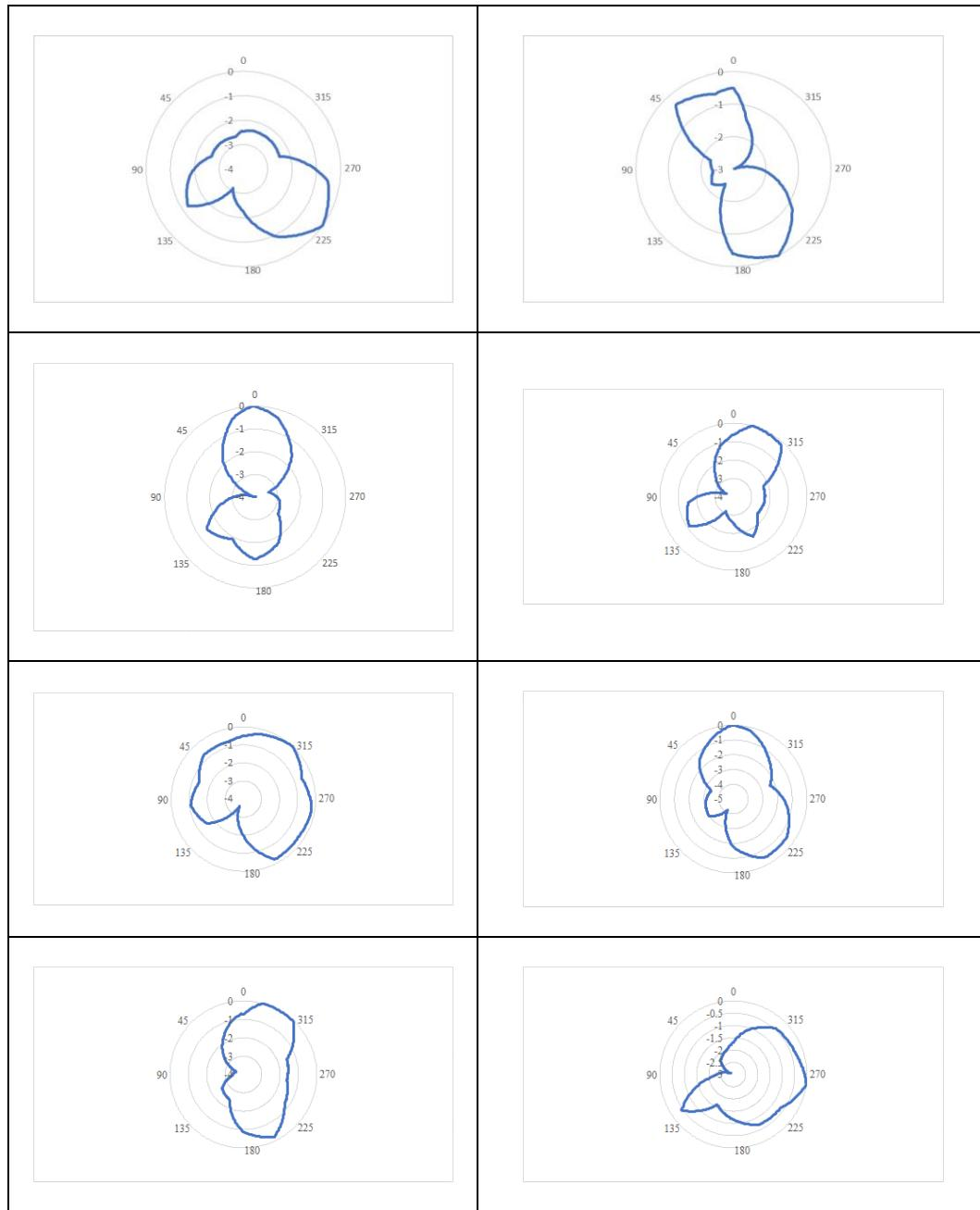
Normalisasi hasil pengukuran pola radiasi antena frekuensi kombinasi S7O1 dan *beam steering* pada frekuensi 5,56 GHz
