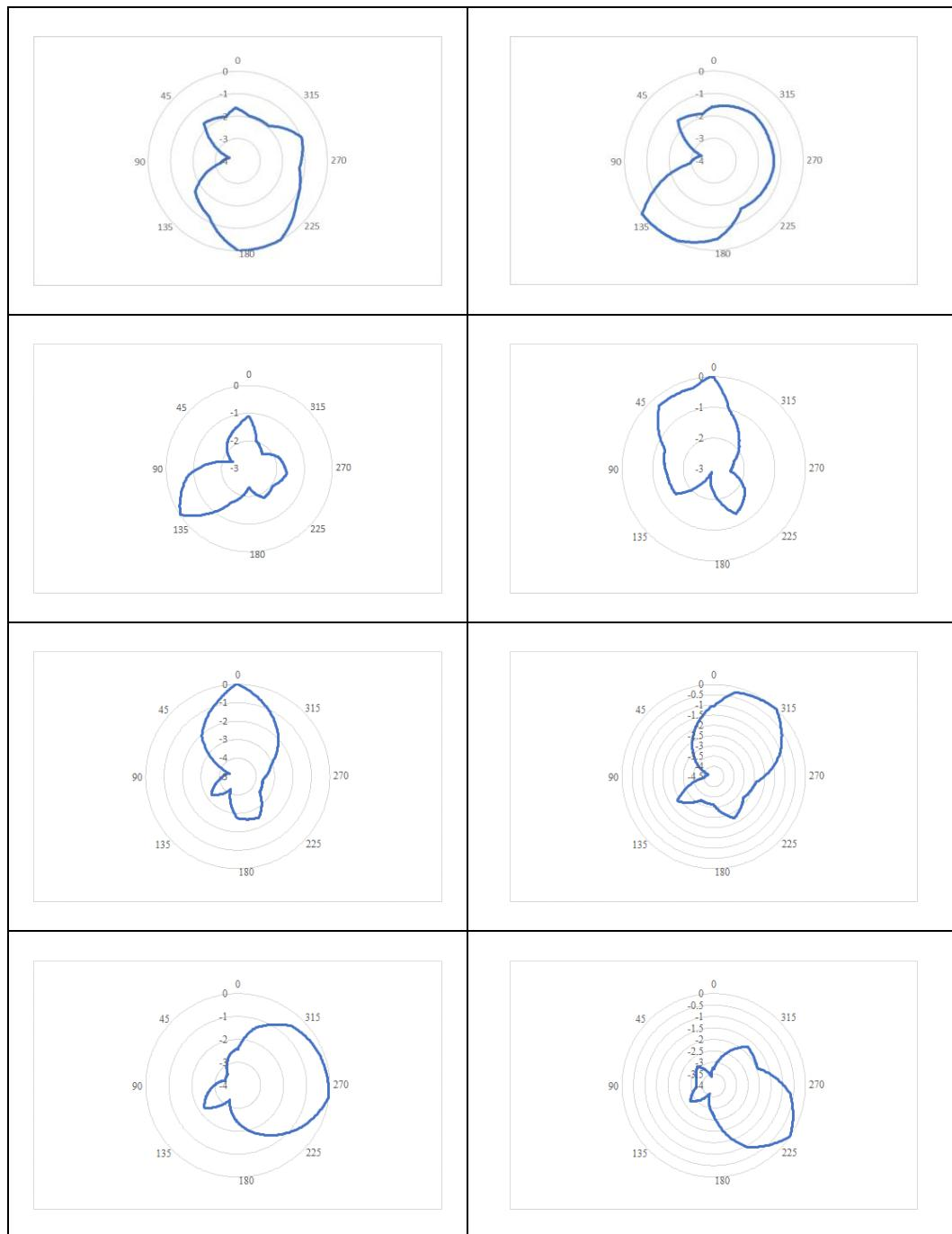
Normalisasi hasil pengukuran pola radiasi antena frekuensi kombinasi S4O4 dan *beam steering* pada frekuensi 5,56 GHz
