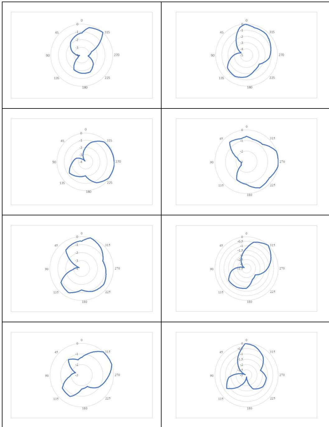
Normalisasi hasil pengukuran pola radiasi antena frekuensi kombinasi S2O6 dan *beam steering* pada frekuensi 5,56 GHz
