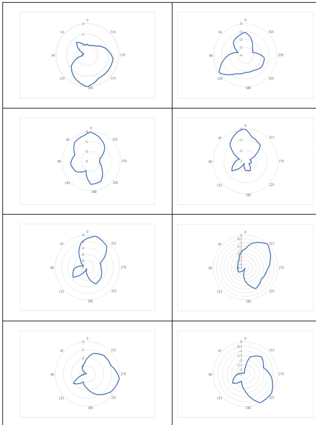
Normalisasi hasil pengukuran pola radiasi antena frekuensi kombinasi S5O3 dan *beam steering* pada frekuensi 5,56 GHz
