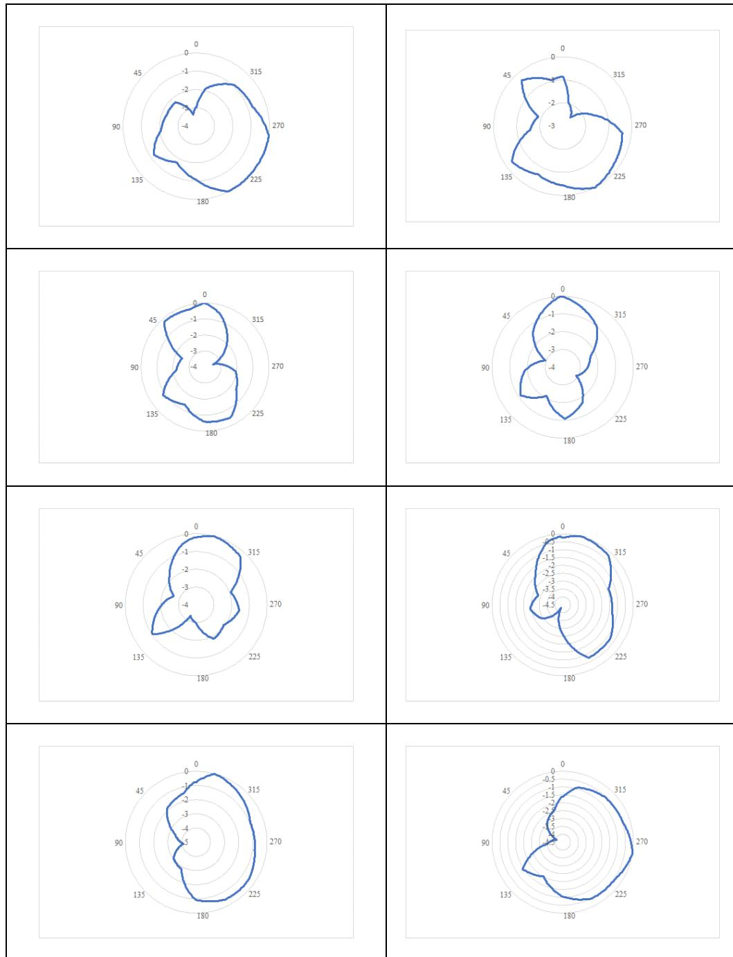
Normalisasi hasil pengukuran pola radiasi antena frekuensi kombinasi S6O2 dan *beam steering* pada frekuensi 5,56 GHz
