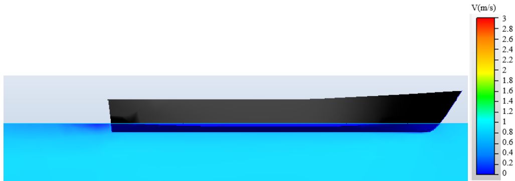
Velocity magnitude model kapal tanpa menggunakan vortex generator pada kecepatan 0,75 m/s dengan trim 0^\circ
