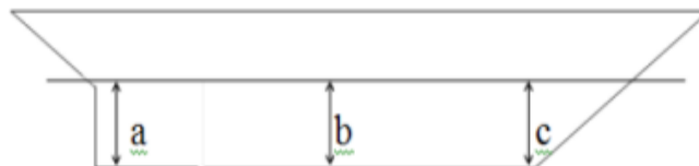
Gambar 2. 6 Kapal Kondisi Even Keel
