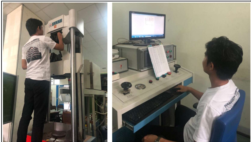
Gambar C.2 Proses penarikan batang tembaga
