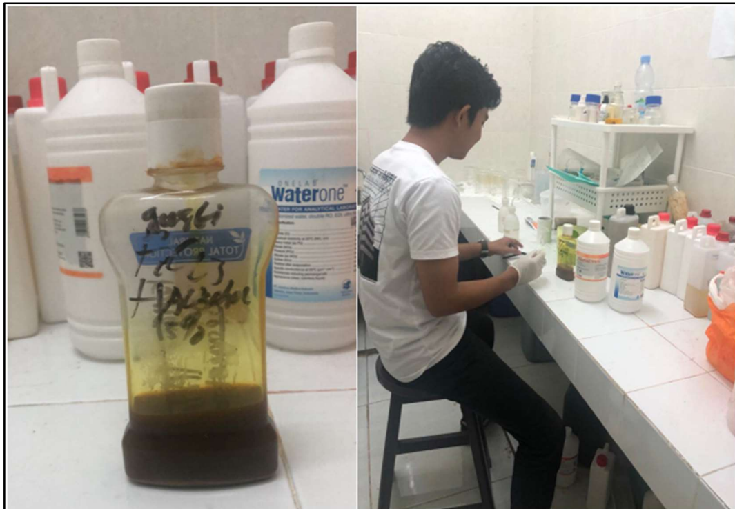
Gambar C.4 Proses Etsa Permukaan Material sebelum proses Metalografi
