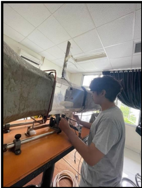
Proses Pemasangan Model Uji Pada Wind Tunnel
