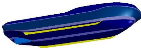
Gambar 6 Ilustrasi penempatan fins pada area bawah lambung kapal
