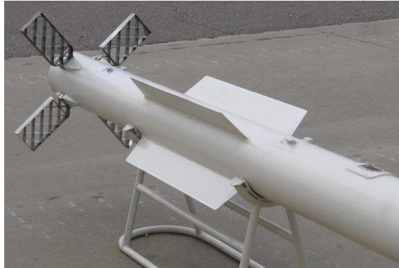
Gambar 5 Grid Fin yang dipasang pada Peluru Kendali
