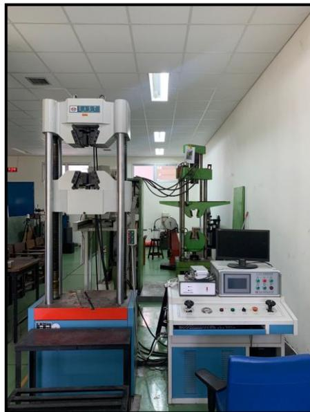
Gambar 26 Mesin Uji Tarik
