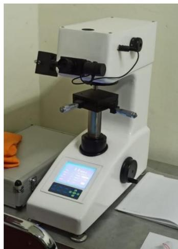
Gambar 22 Alat uji kekerasan metode *Vickers*
