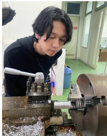
5. Melakukan Setting Parameter Pembubutan
