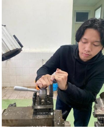
4. Melakukan Centerdrill pada Pahat
