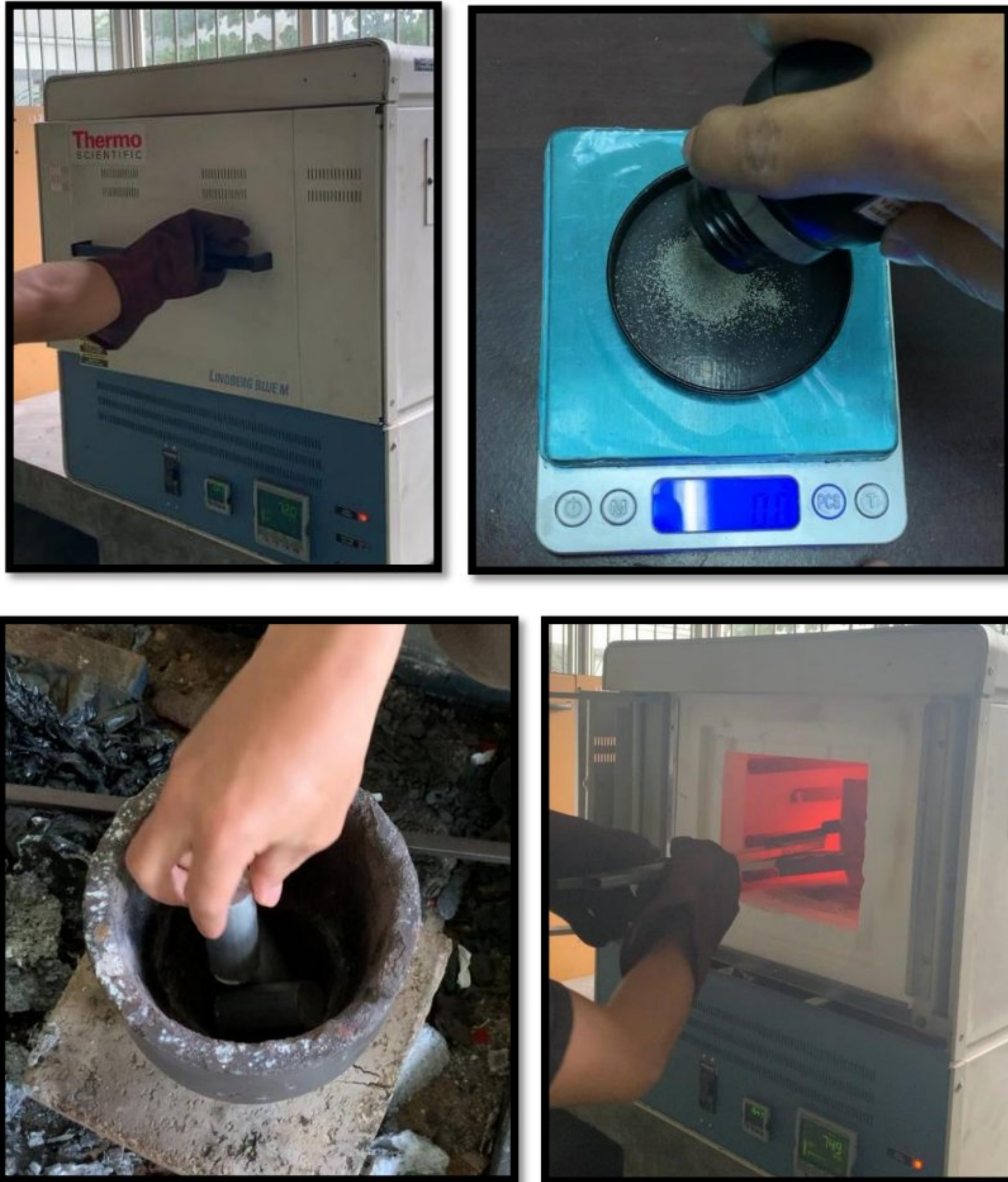
Gambar B.1 Proses pengecoran/pembuatan spesimen
