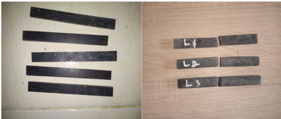
SPESIMEN UJI BENDING SEBELUM DAN SETELAH PENGUJIAN
