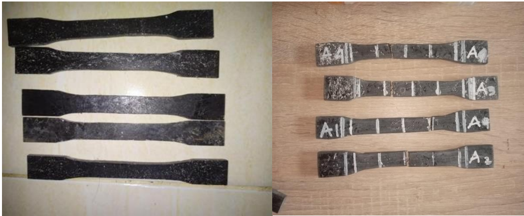
SPESIMEN UJI TARIK SEBELUM DAN SETELAH PENGUJIAN
