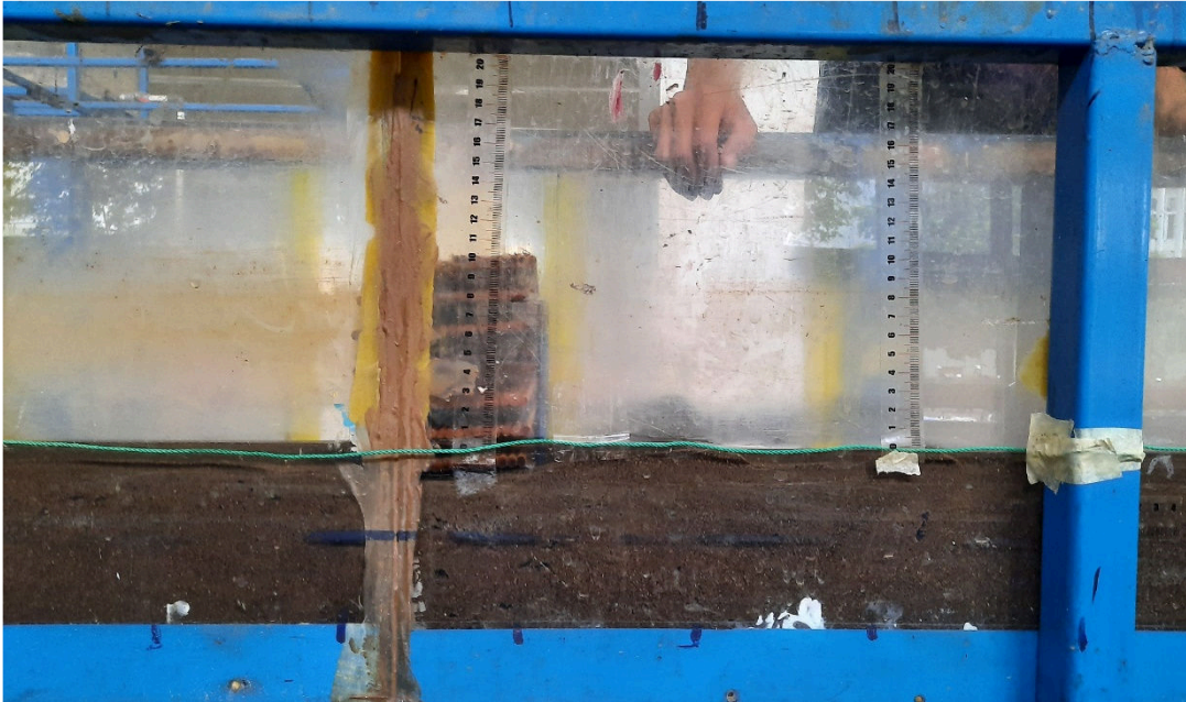
Kedalaman gerusan pada model struktur \zeta=61\% pada i=0.012 dengan \gamma_s=2.71 \text{ gr/cm}^3
