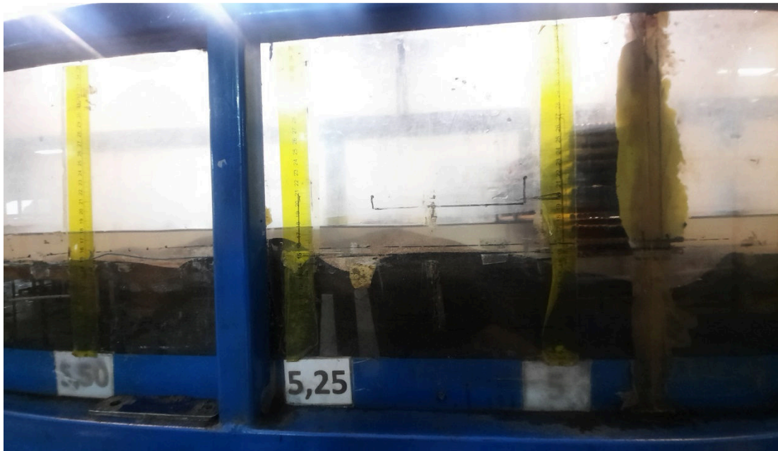
Kedalaman gerusan pada model struktur \zeta=48\% pada i=0.012 dengan \gamma_s=2.71 \text{ gr/cm}^3
