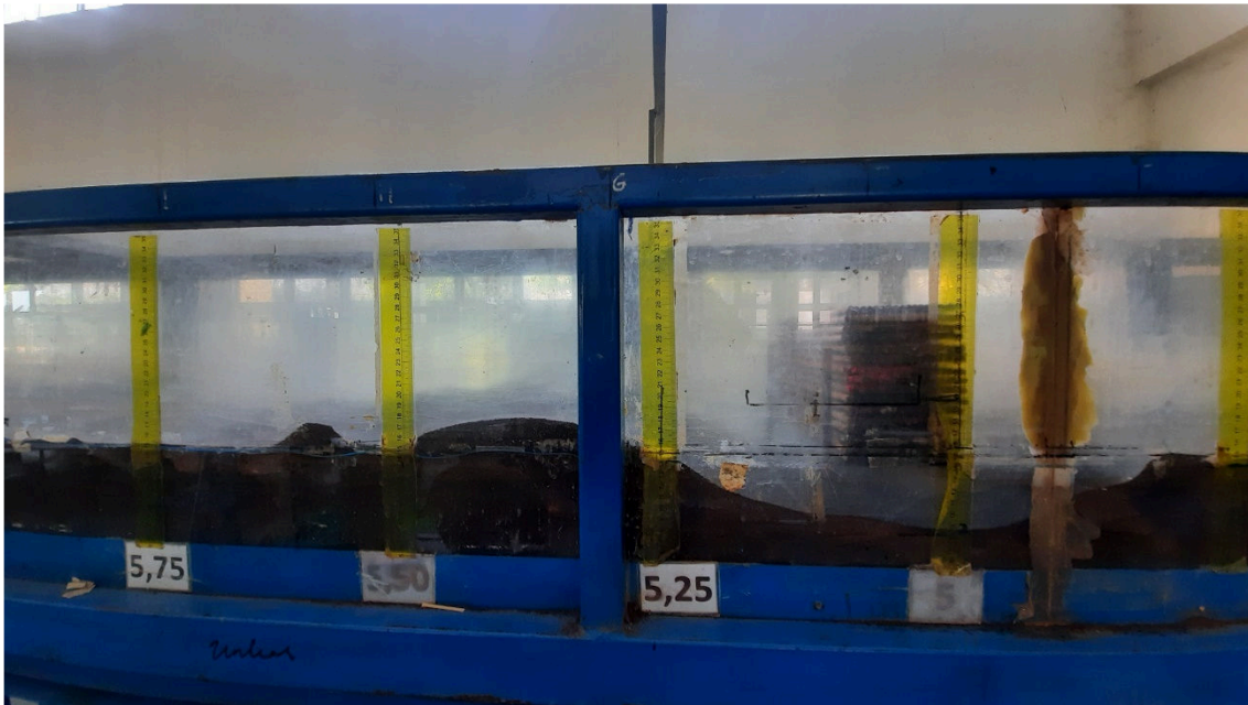
Kedalaman gerusan pada model struktur \zeta=25\% pada i=0.012 dengan \gamma_s=2.80 \text{ gr/cm}^3
