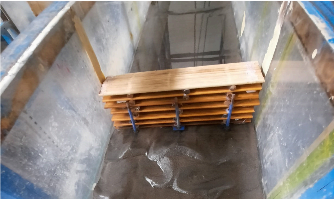
Pola gerusan di bagian hulu pada model struktur \zeta=61\% pada i=0.012 dengan \gamma_s=2.71 \text{ gr/cm}^3
