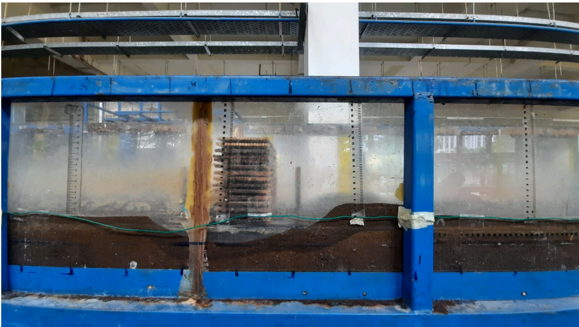
Kedalaman gerusan pada model struktur \zeta=48\% pada i=0.012 dengan \gamma_s=2.80 \text{ gr/cm}^3
