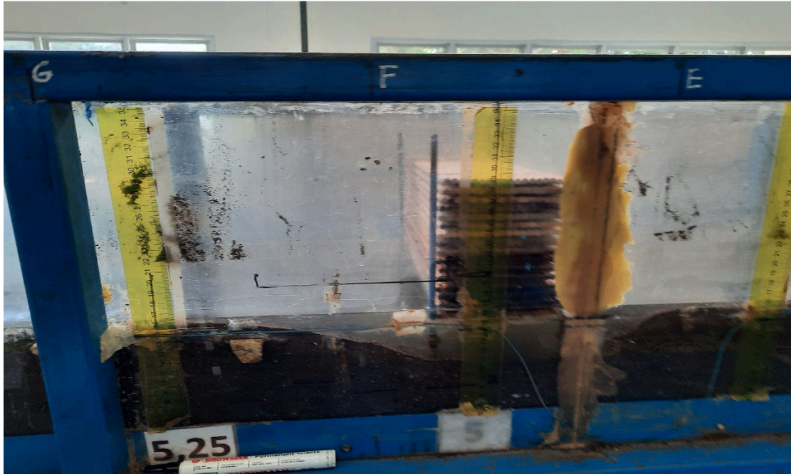
Kedalaman gerusan pada model struktur \zeta=25\% pada i=0.012 dengan \gamma_s=2.79 \text{ gr/cm}^3
