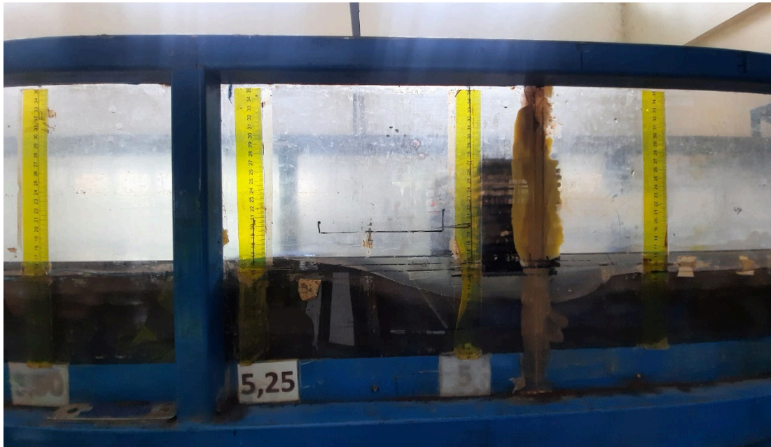
Kedalaman gerusan pada model struktur \zeta=25\% pada i=0.012 dengan \gamma_s=2.71 \text{ gr/cm}^3
