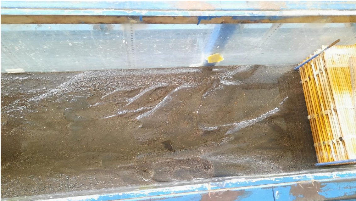
Pola gerusan di bagian hulu pada model struktur \zeta=61\% pada i=0.012 dengan \gamma_s=2.79 \text{ gr/cm}^3
