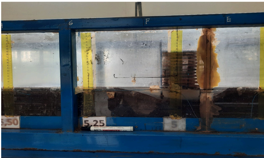
Kedalaman gerusan pada model struktur \zeta=48\% pada i=0.012 dengan \gamma_s=2.79 \text{ gr/cm}^3
