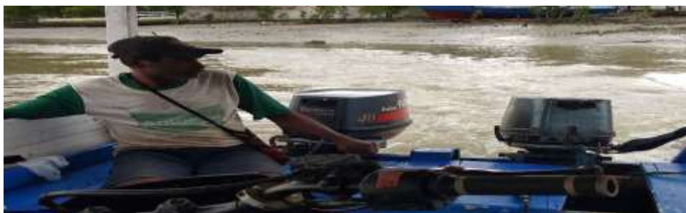
Gambar 32. Jumlah mesin tempal 2 mesin 40 dan 15 PK
