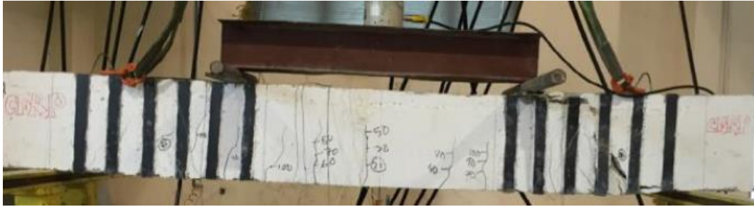
Gambar 9. Modulus kegagalan balok diperkuat pelat CFRP
