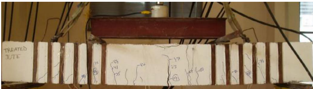
Gambar 7. Modul kegagalan balok diperkuat TJ
