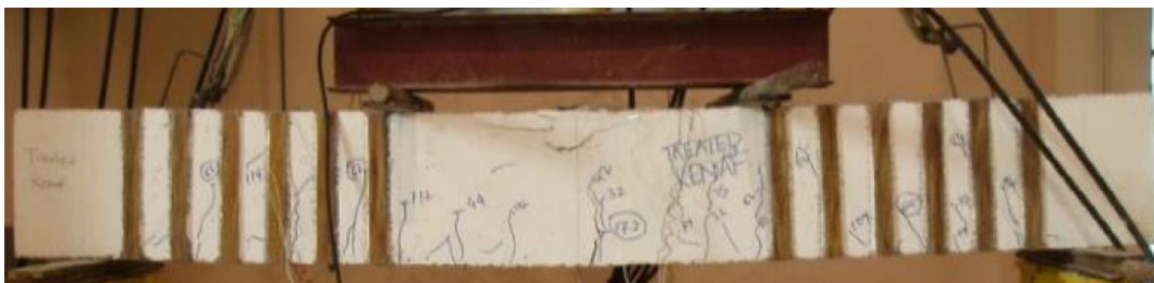
Gambar 6. Modul kegagalan balok perkuatan TK
