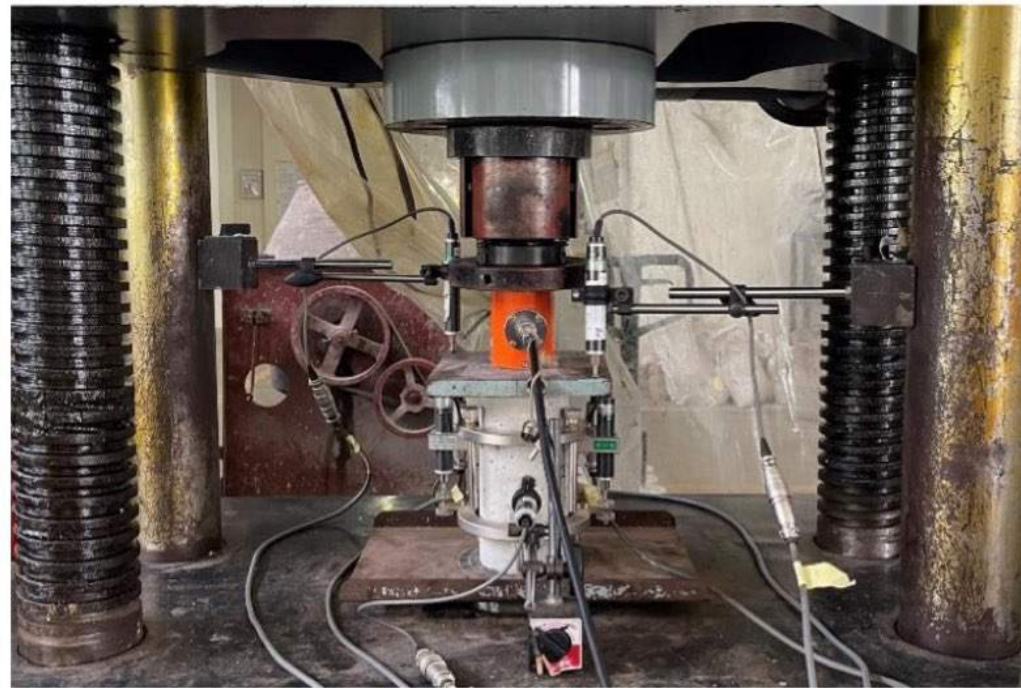
Gambar 7. Ilustrasi Pengujian Kekuatan Tekan
