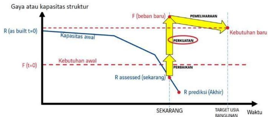
**Gambar 5.** Konsep perbaikan dan perkuatan struktur
