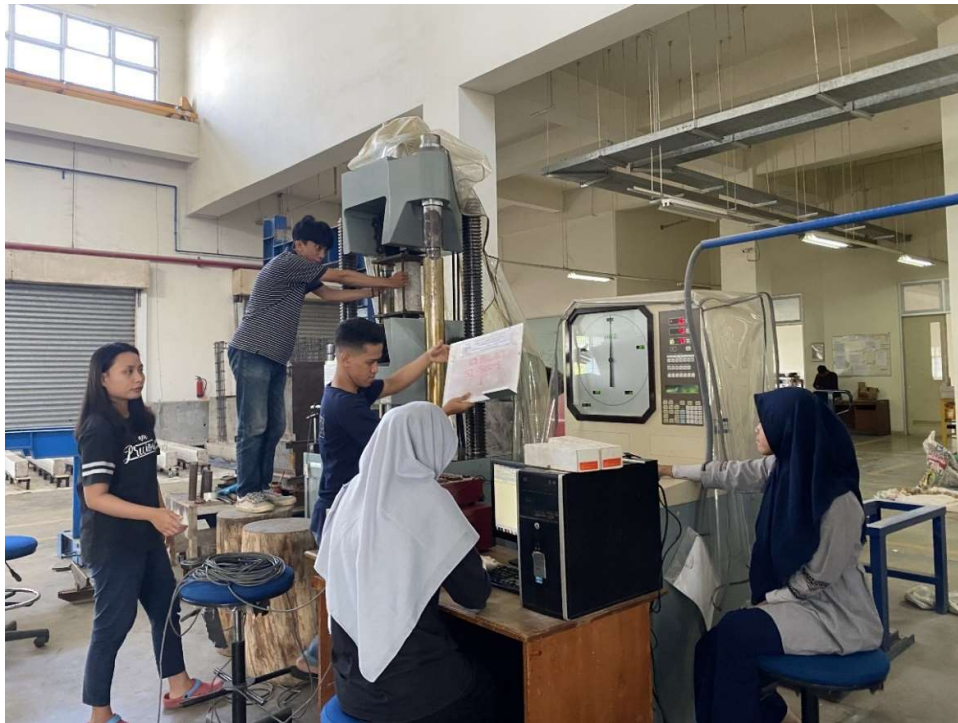
Persiapan Pengujian Pull Out
