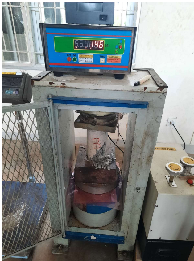
Pengujian Kekuatan Tekan Beton
