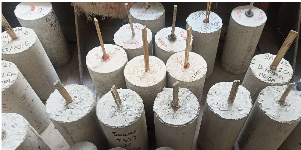
Perawatan Benda Uji
