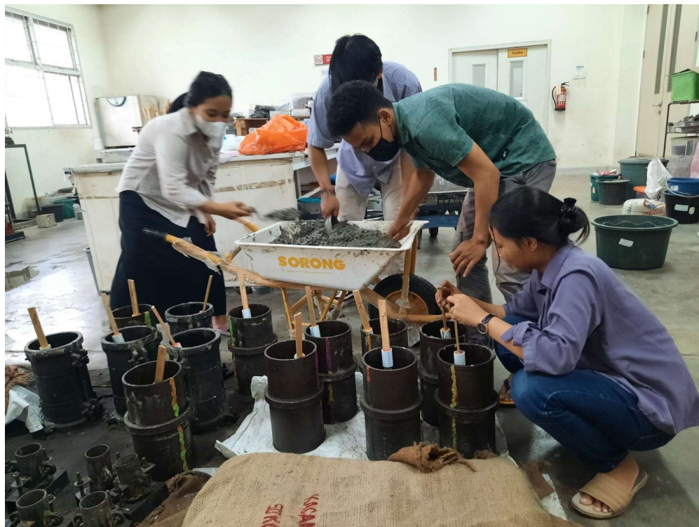
Penuangan Beton Segar Kedalam Cetakan
