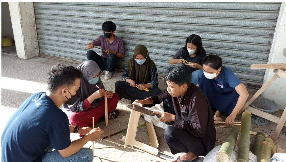
Pembuatan Takikan Pada Bambu
