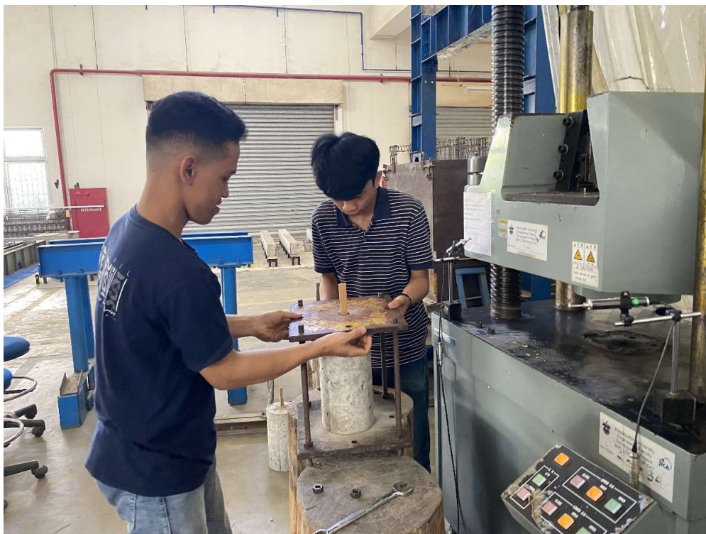
Pemasangan Sampel Uji Pull Out ke Frame Pull Out
