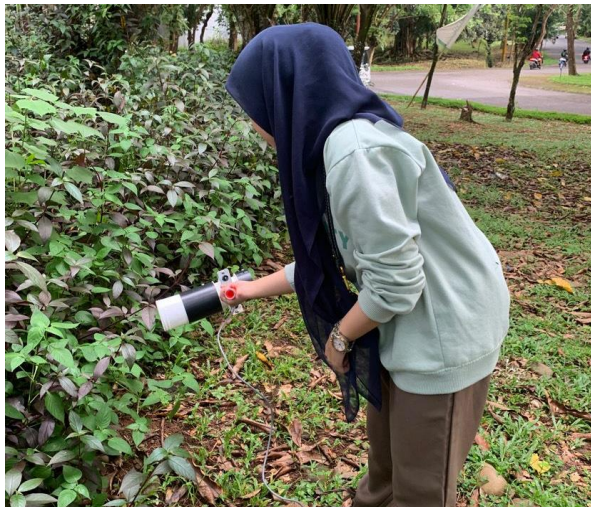
Gambar 7.4 Penangkapan nyamuk menggunakan alat insect zooka
