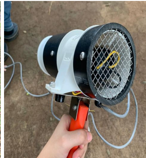
Gambar 7.4 Penangkapan nyamuk menggunakan alat insect zooka
