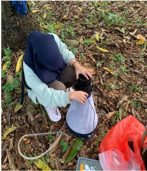
Gambar 7.3 Pemasangan alat Bg-trap untuk menangkap nyamuk
