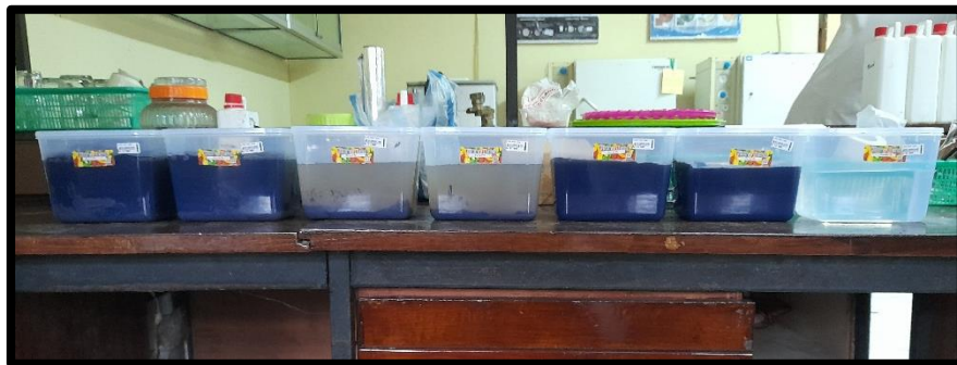
Desain bioreaktor dengan pemberian sedimen rawa dan biochar dari tempurung kelapa sebagai sumber inokulum bakteri pereduksi sulfat
