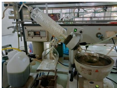
Ekstrak maserat diuapkan menggunakan rotary evaporator
