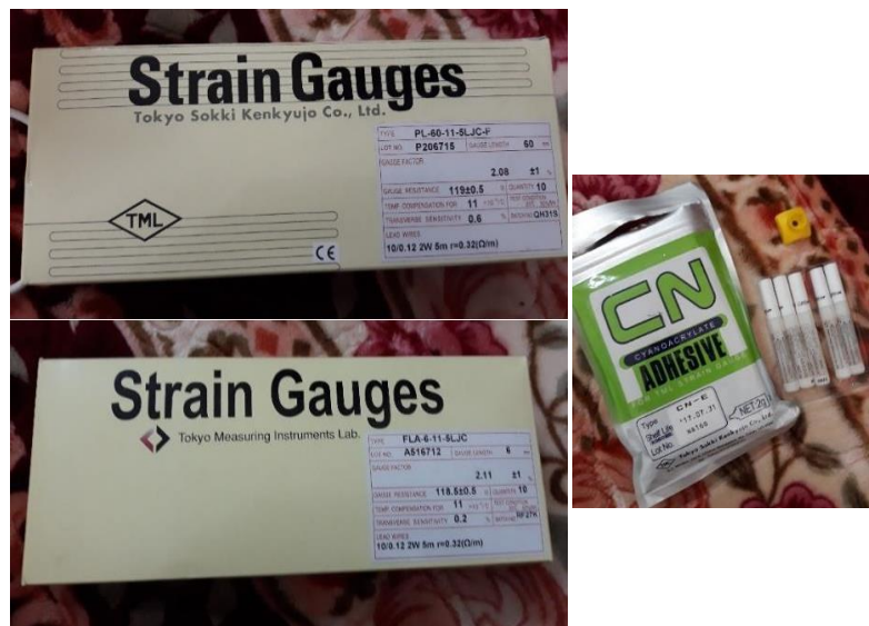
Strain Gauges untuk Tulangan dan Beton, serta CN Adhesive
