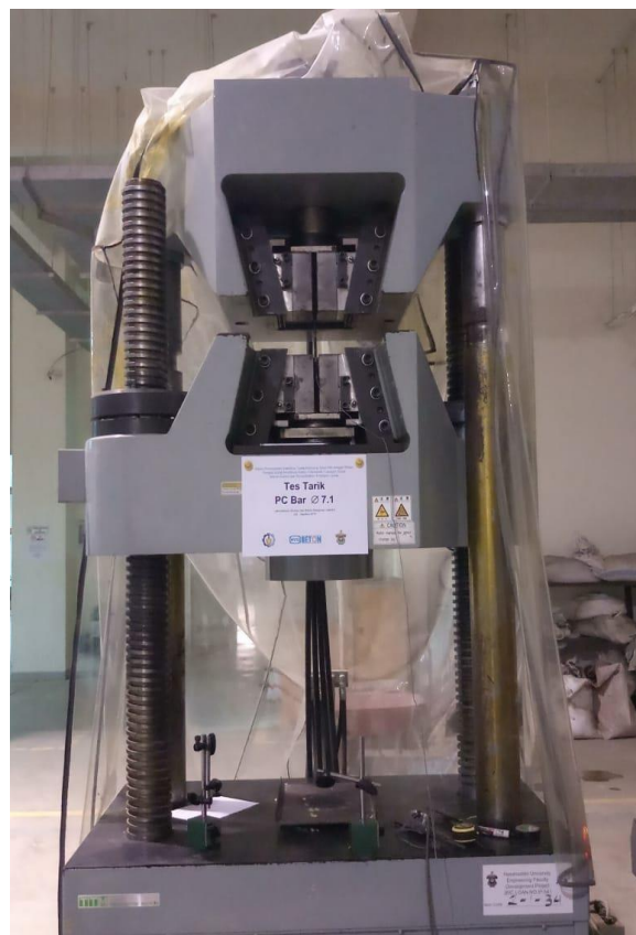
Gambar 14 Pengujian Kuat Tarik Tulangan
