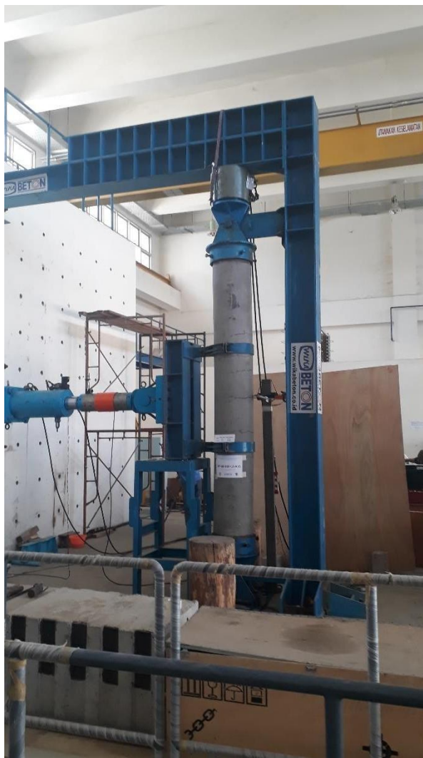
Gambar 7 Setting alat dan benda uji tes lentur siklik
