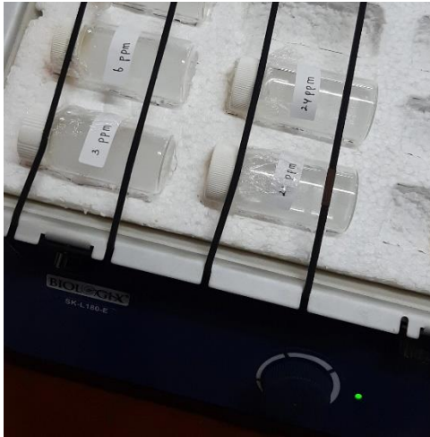
Pengocokan dengan alat shaker untuk pengaruh waktu dan konsentrasi terhadap adsorpsi DBP
