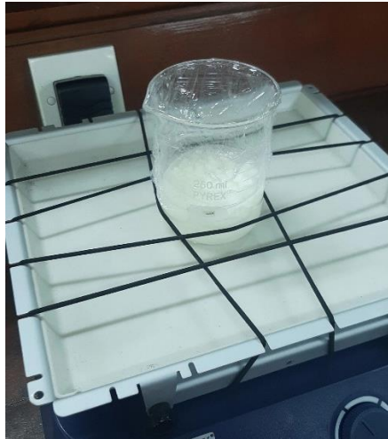
Proses pencucian polimer dengan aseton, metanol, dan akuades agar bersih dari pengotor
