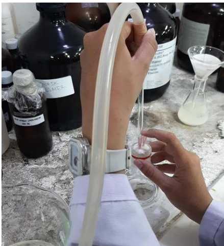
Pengaliran gas nitrogen untuk menghilangkan gas oksigen
