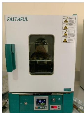
Pengeringan Oven Blower
