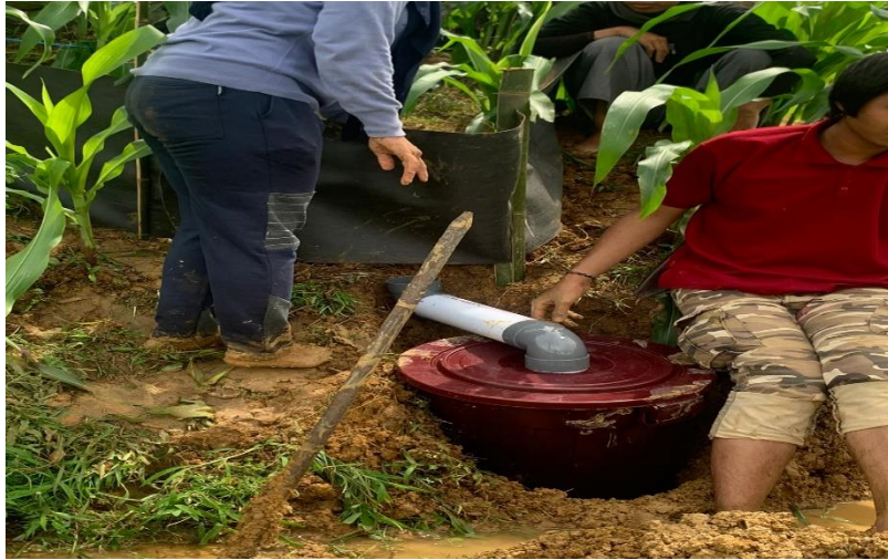
Lampiran 4. Perakitan plot erosi pada pertanaman jagung di Desa Pucak, Kec. Tompobulu, Kab. Maros
