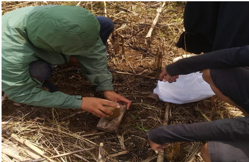
Lampiran 5. Pengambilan sampel utuh dan terganggu pada pertanaman jagung di Desa Pucak, Kec. Tompobulu, Kab. Maros
