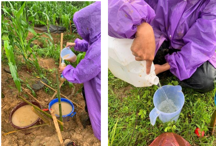
Lampiran 8. Pengukuran aliran permukaan dan air hujan tertampung pada pertanaman jagung di Desa Pucak, Kec. Tompobulu, Kab. Maros
