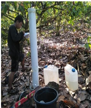
Pemasangan pipa mariotte
