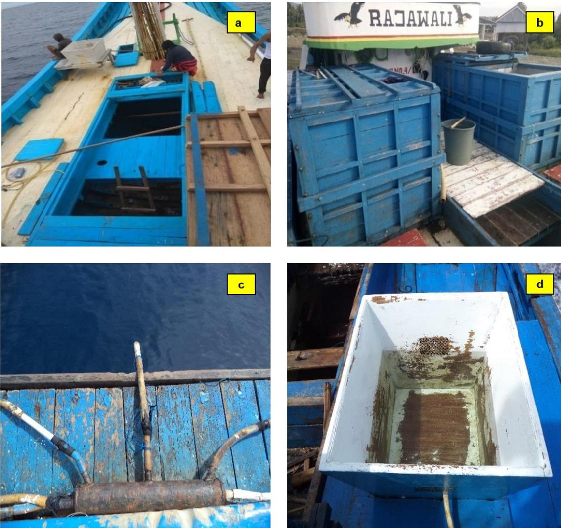
Gambar 7. Model Bak Umpan (a), Palka (b), pipa penyemprot air (c), dan Pot Umpan (d) yang Terdapat pada Kapal Pole and Line yang Dioperasikan di Perairan Teluk Bone, Sulawesi Selatan.
