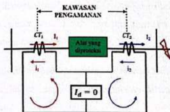
Gambar 7 Relai Diferensial Saat Terjadi Gangguan Diluar Daerah Proteksi (Muharram, 2018)
