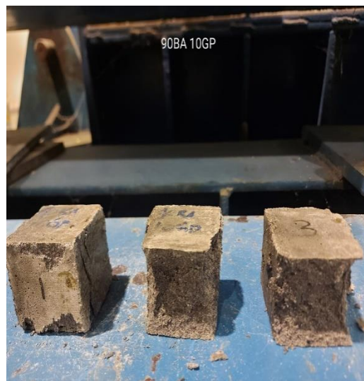
Alat pengujian kuat tekan pada sampel mortar ramah lingkungan
