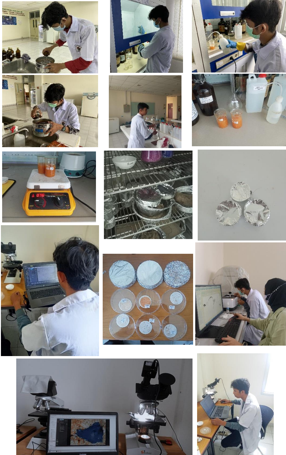
Proses penyaringan mikroplastik hingga proses pengamatan mikroplastik di mikroskop dan pengamatan jenis polimer pada alat spectroscopy FTIR
