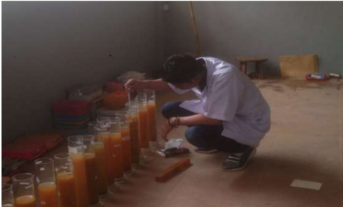
Gambar 15. Analisis Tekstur Sampel Tanah
