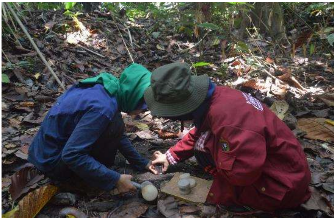
Gambar 4. Pengambilan Sampel Tanah Hutan Sekunder
