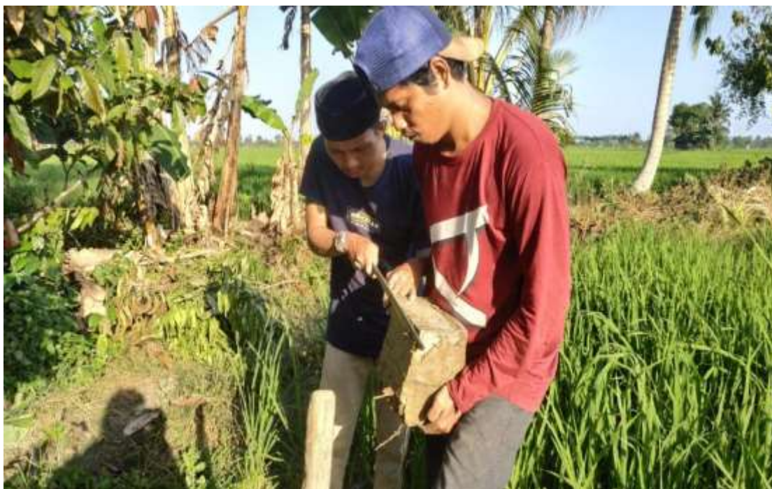
Gambar 11. Pengambilan Sampel Tanah Sawah
