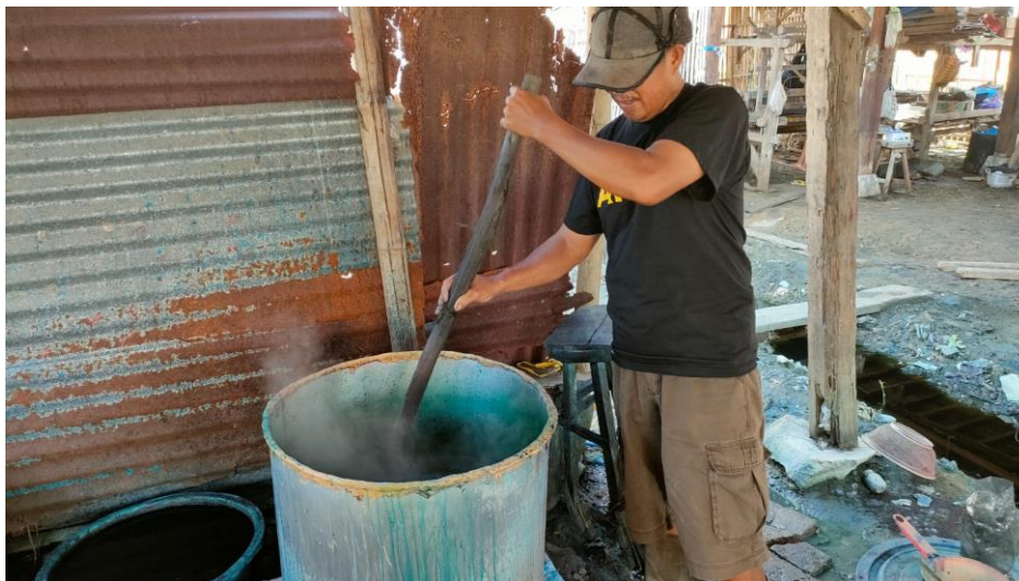
Gambar 9. Proses pewarnaan pembilasan benang / kain sutera (Sumber : dokumentasi pribadi)
