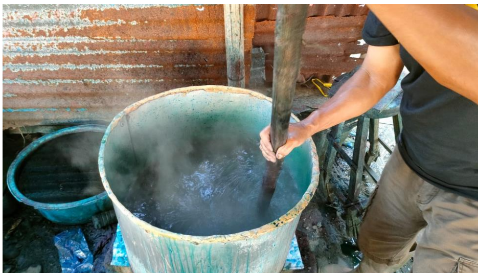
Gambar 10. Benang / Kain Sutera dimasukkan dalam wadah air mendidih (Sumber : dokumentasi pribadi)
