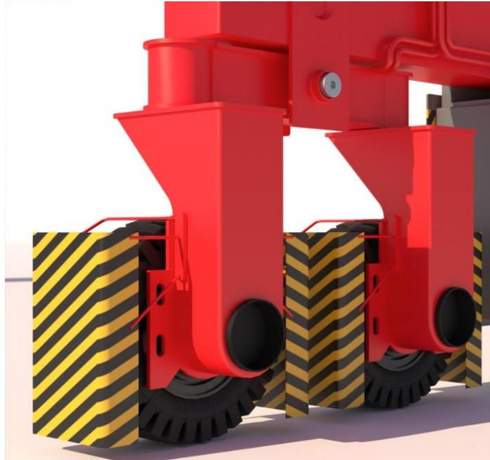
**Gambar 2.5** Roda karet pada RTG Crane
