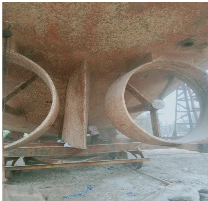
Gambar 2.10 Korosi pada Buritan Kapal
