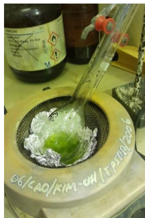
Proses destruksi (analisis kadar protein metode Kjeldahl)
