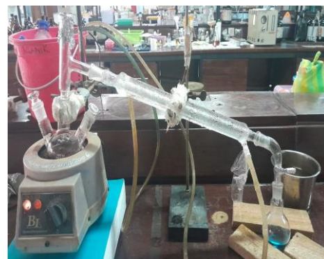
Proses distilasi (analisis kadar protein metode Kjeldahl)
