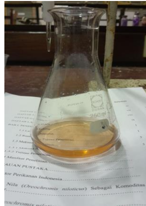
Hasil titrasi (analisis kadar protein metode Kjeldahl)
