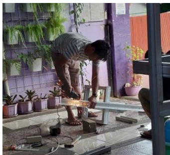
Gambar 4. Pembuatan rangka lampu perangkap.
