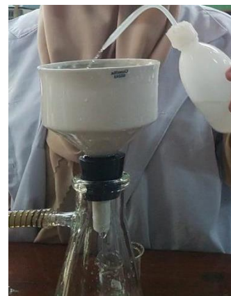
Pencucian dengan akuades hingga pH netral
