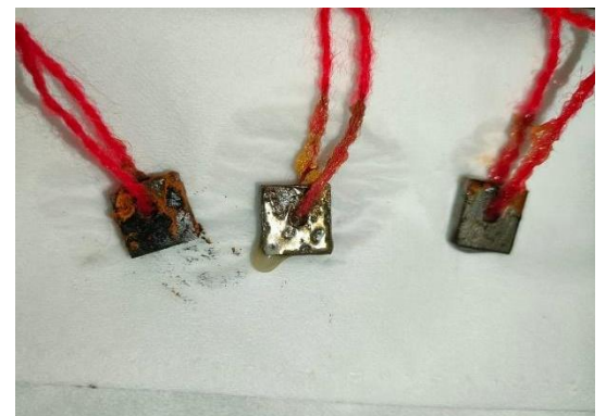
Pengangkatan baja tanpa inhibisi, dengan inhibisi dan RH dalam media akuades
