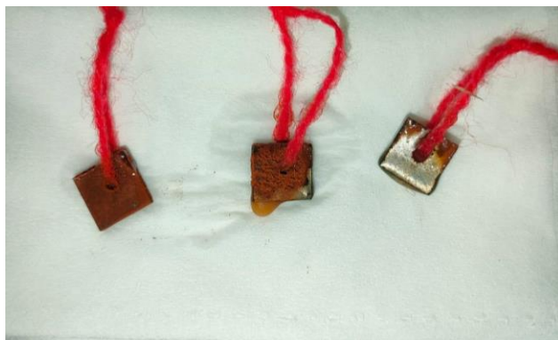
Pengangkatan baja tanpa inhibisi, dengan inhibisi dan RH dalam media air laut
