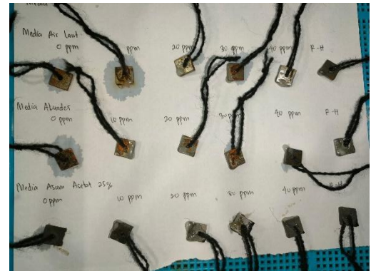
Pengangkatan baja dengan perendaman selama 4 hari
