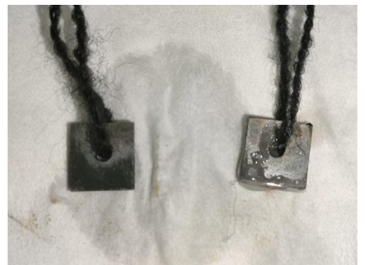
Permukaan baja tanpa inhibisi dengan inhibisi dalam media asam asetat
