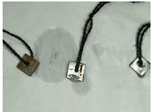
Pengangkatan baja tanpa inhibisi, dengan inhibisi dan RH dalam media air laut
