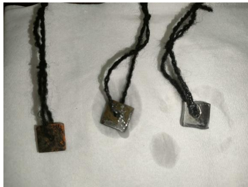
Pengangkatan baja tanpa inhibisi, dengan inhibisi dan RH dalam media akuades
