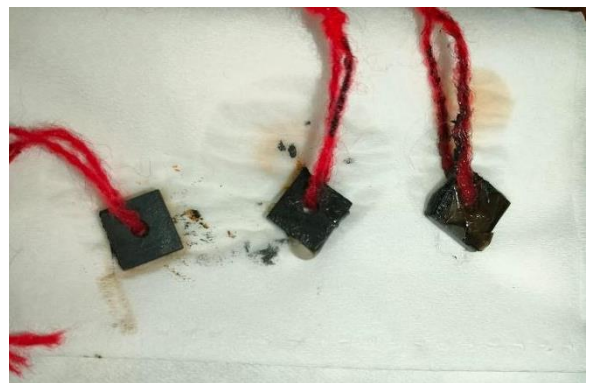
Pengangkatan baja tanpa inhibisi, dengan inhibisi dan RH dalam media asam asetat
