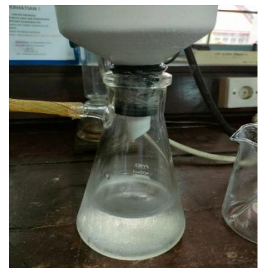
Penyaringan dari pencucian dengan akuades
