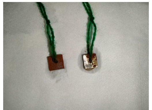
Permukaan baja tanpa inhibisi dengan inhibisi dalam media akuades
