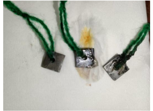
Pengangkatan baja tanpa inhibisi, dengan inhibisi dan RH dalam media asam asetat
