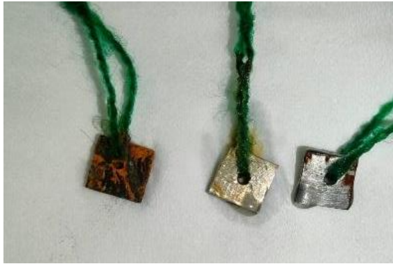
Pengangkatan baja tanpa inhibisi, dengan inhibisi dan RH dalam media air laut
