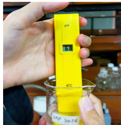
Penentuan pH setelah polimer dicuci dengan akuades
