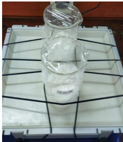
Proses pencucian polimer dengan aseton, methanol, dan akuades untuk menghilangkan pengotor
