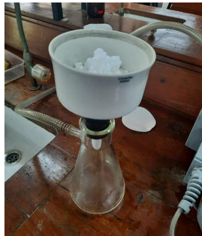
Proses pencucian polimer dengan aseton, methanol, dan akuades untuk menghilangkan pengotor
