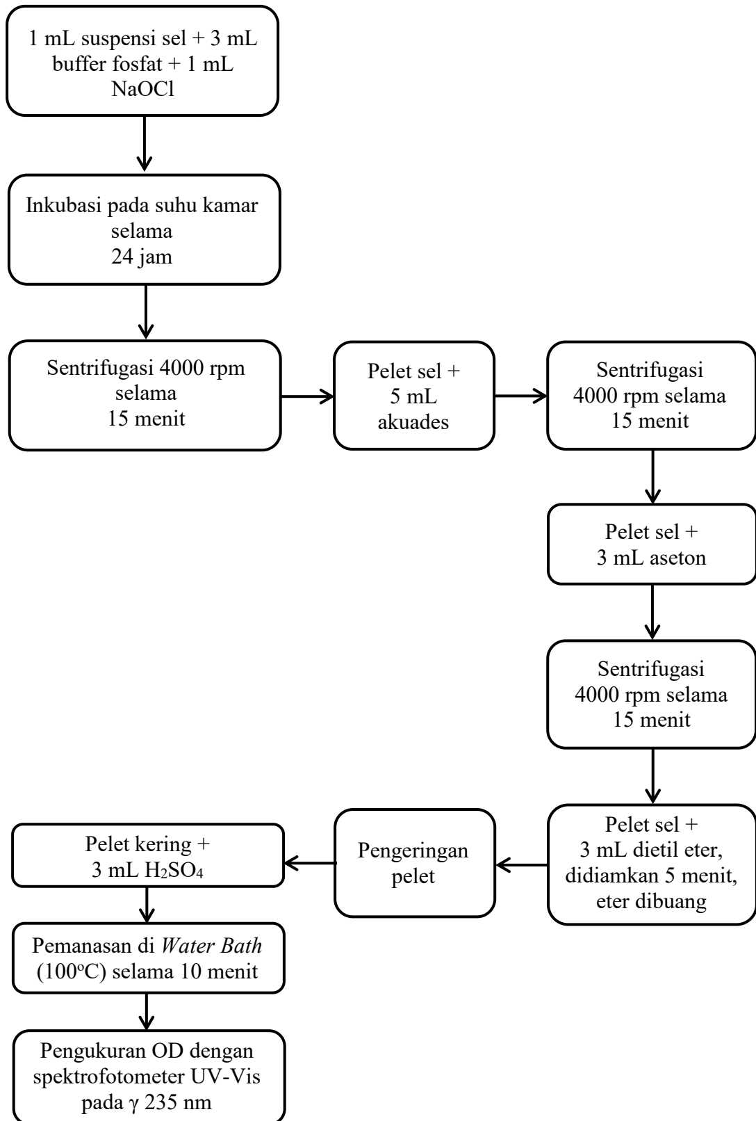
Lampiran 6. Skema Kerja Analisis Polyhydroxyalkanoate (PHA) Menggunakan Spektrofotometer UV-Vis
