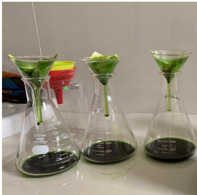
Gambar 19. Proses penyaringan ekstrak ethanol 96% daun sirsak ( Annona muricata L. )
