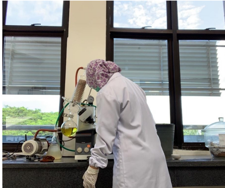
Gambar 20. Proses pemisahan pelarut ethanol 96% dari ekstrak yang sudah terbentuk melalui alat rotarory evaporator.
