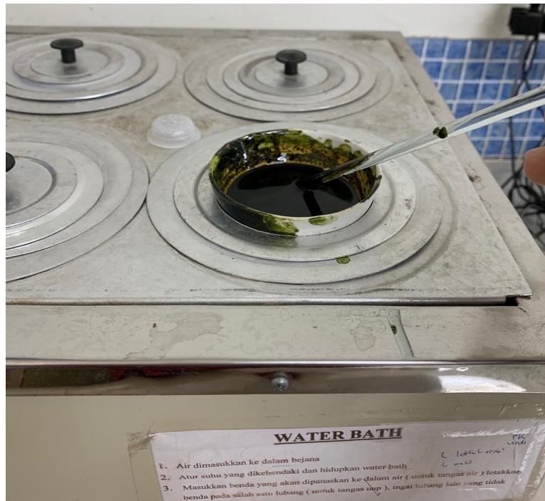
Gambar 21. Proses pemanasan ekstrak cair daun sirsak menjadi ekstrak kental melalui alat waterbath
