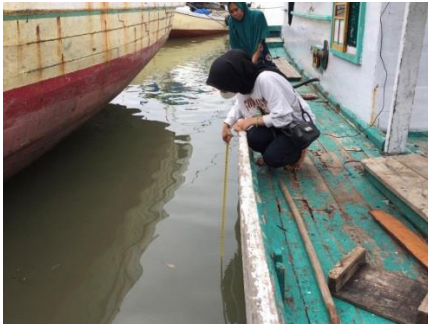
Pengukuran jarak aman dari lunas kapal ke dasar perairan
