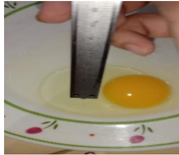
Gambar 10. Pengukuran Tinggi Albumin Telur
