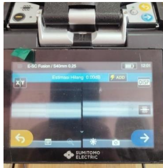
Gambar 18 Proses penyambungan core yang tampak pada LCD
