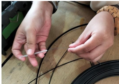
Gambar 12 Pemasangan sleeve protection pada ujung serat
