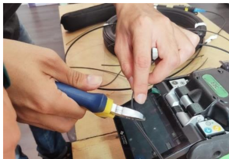
Gambar 13 Pengelupasan coating pada kabel serat optik
