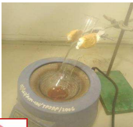
Proses destruksi (Analisis kadar protein metode Kjeldahl )
