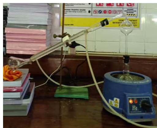
Proses destilasi (Analisis kadar protein metode Kjeldahl )
