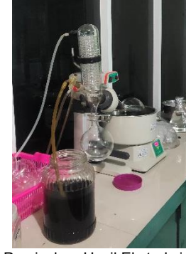
Pemisahan Hasil Ekstraksi di Rotarievaporator
