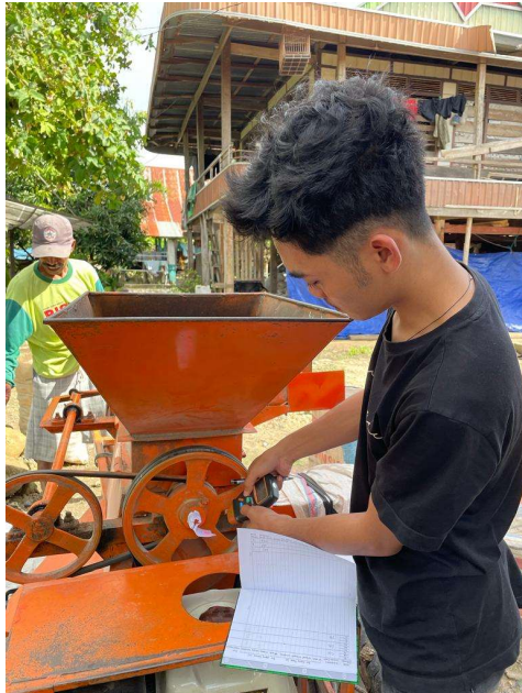
Mengukur kecepatan putaran poros silinder dengan menggunakan Tachometer.
